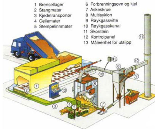
Figur 53 Hovedkomponenter i et flisanlegg
